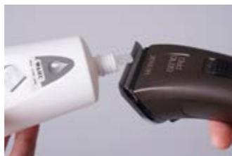
3. Den Schneidsatz wieder aufklappen. Ölen mit Spezial-Schneidsatzöl an markierten Stellen. Maschine 10 Sekunden lang anschalten, um das Öl gleichmäßig zu verteilen.
