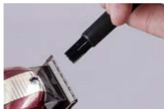
2. Schneidsatz mit Pinsel reinigen.
