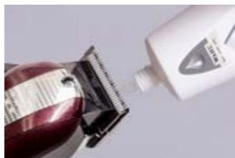
3. Ölen mit Spezial-Schneidsatzöl an markierten Stellen. Maschine 10 Sekunden lang anschalten, um das Öl gleichmäßig zu verteilen.
