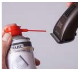
Nutzen Sie außerdem das Blade Ice während und nach dem Schneiden zur Kühlung und Reinigung des Schneidsatzes.
